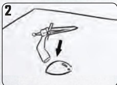
Окуните отломанную деталь в каплю клея в месте поломки — точке контакта.
